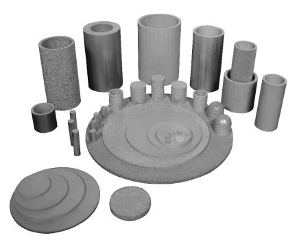
烧结金属粉末多孔材料是采用模压成型再经过烧结工艺制备的金属粉末多孔材 料,具有良好的渗透性,孔径与 孔隙度可控,耐高温,抗腐蚀性好、可再生等优点,可以采用多种材质,如不锈钢、青铜、高温合金等。
