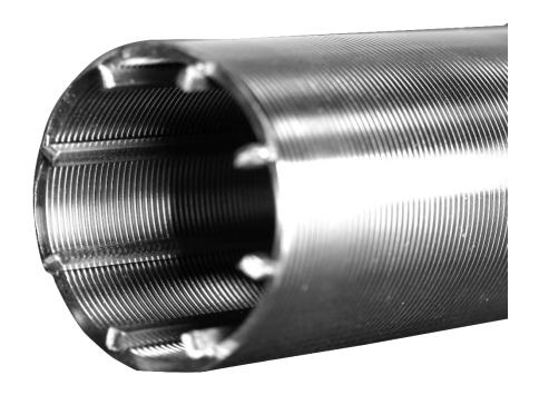
楔形网(Wedge Wire Screen),又称为约翰逊滤网(Johnson Screen);是应用特制不锈钢梯形(楔形) 丝(绕条)绕组在一圆周式排列的一组纵向支撑杆(筋条、 托条)上焊制而成的滤芯,其筛管 缝隙间会形成明显的 V 字形开口。
